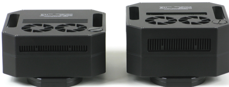
Obr. 5: Porovnání kamer se standardním (vlevo) a posíleným (vpravo) chlazením
