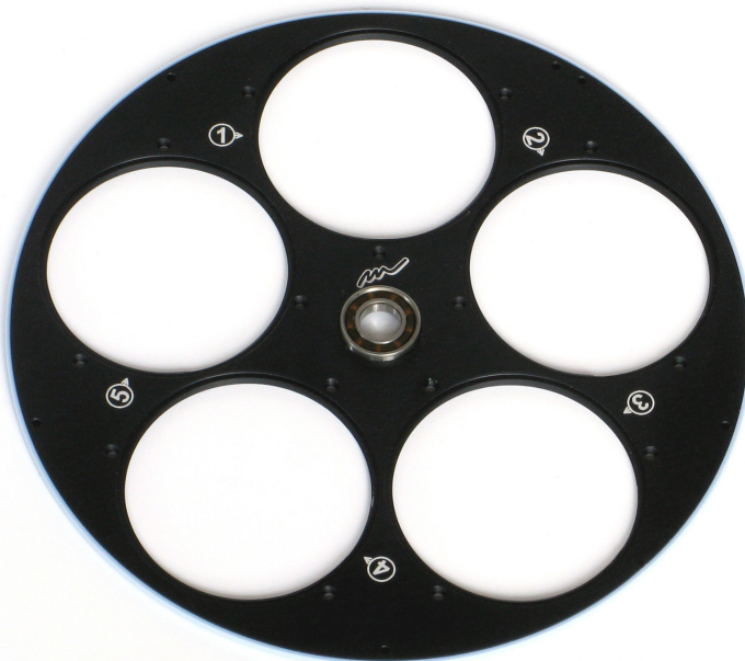
Obr. 23: Pozice filtrů ve filtrovém kole kamer G3
